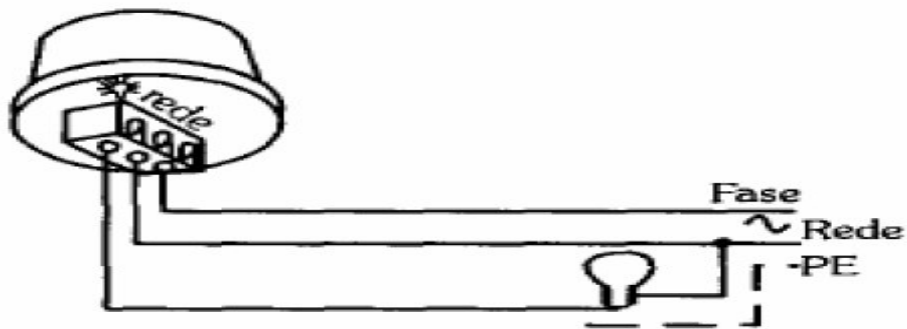
Figura 164 – Relé instalado sem interruptor.
