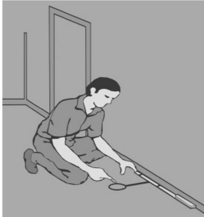
Figura 130 – Marcação da posição do interruptor no piso.
