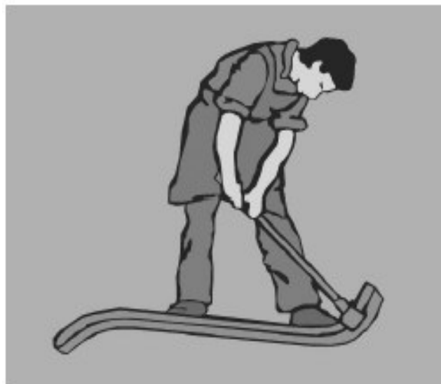
Figura 106 – Curvando o eletroduto.
