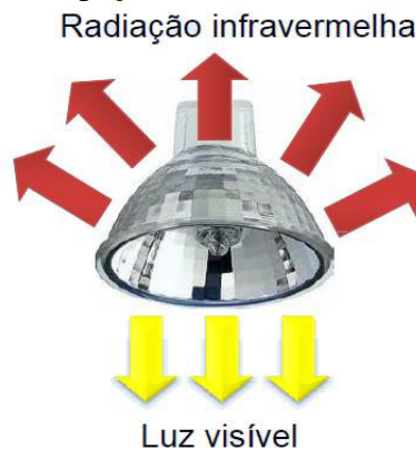
Figura 12 – Dissipação da luz visível e infravermelha.
