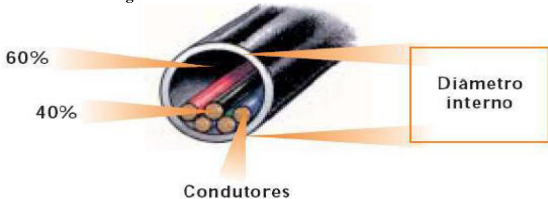
Figura 103 – Condutores no interior do eletroduto.
